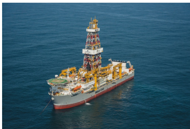
O Gêmeo Digital é um modelo virtual que replica, em tempo real, a operação de um navio sonda. Inicialmente aplicado à embarcação Brava Star, ele integra sistemas dinâmicos de movimentação, geração de energia, emissão de poluentes e confiabilidade operacional. Essa integração permite simular, monitorar e prever o comportamento da unidade, otimizando o consumo de combustível e reduzindo as emissões sem comprometer a segurança ou a confiabilidade das operações.
